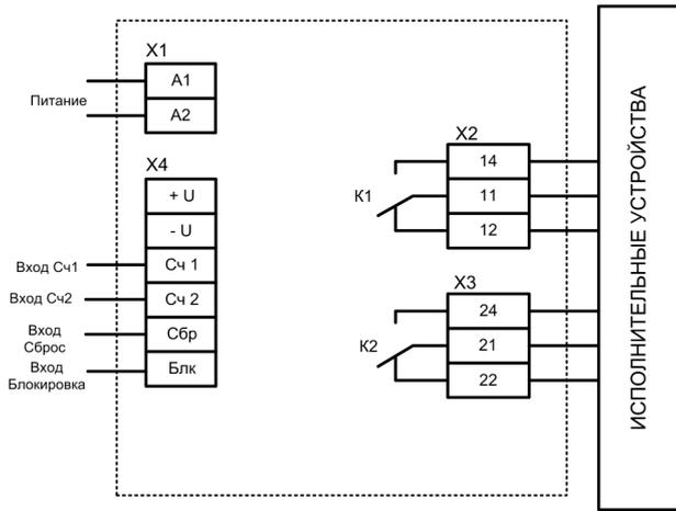
Схема подключения СИМ-05-4-09
